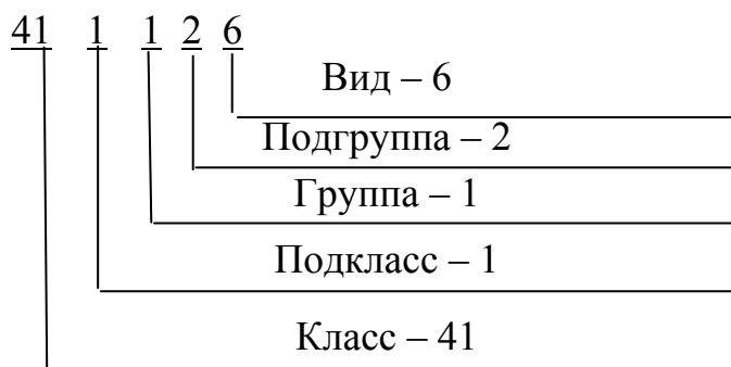
Рис. 14. Структура классификационной характеристики для цифрового вольтметра постоянного и переменного тока
