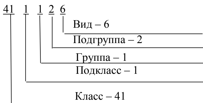
Рисунок 7 Структура классификационной характеристики цифрового вольтметра
