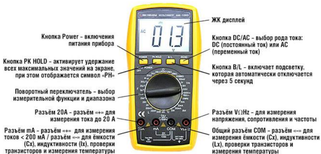
Рис. 6. Краткое описание измеряемых параметров и их обозначение мультиметра.
