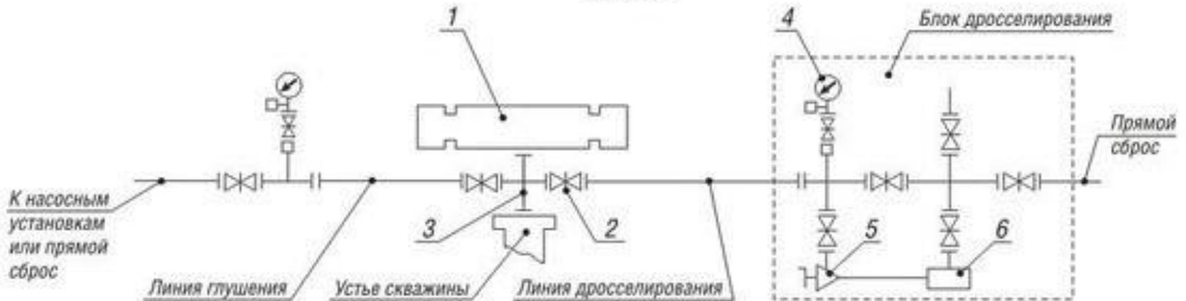
1. Плащечный превентор 2. Задвижка с ручным управлением 3. Устьевая крестовина 4. Манометр с запорным и разрядным устройствами и разделителем сред 5. Дроссель регулируемый с ручным управлением 6. Гаситель потока
