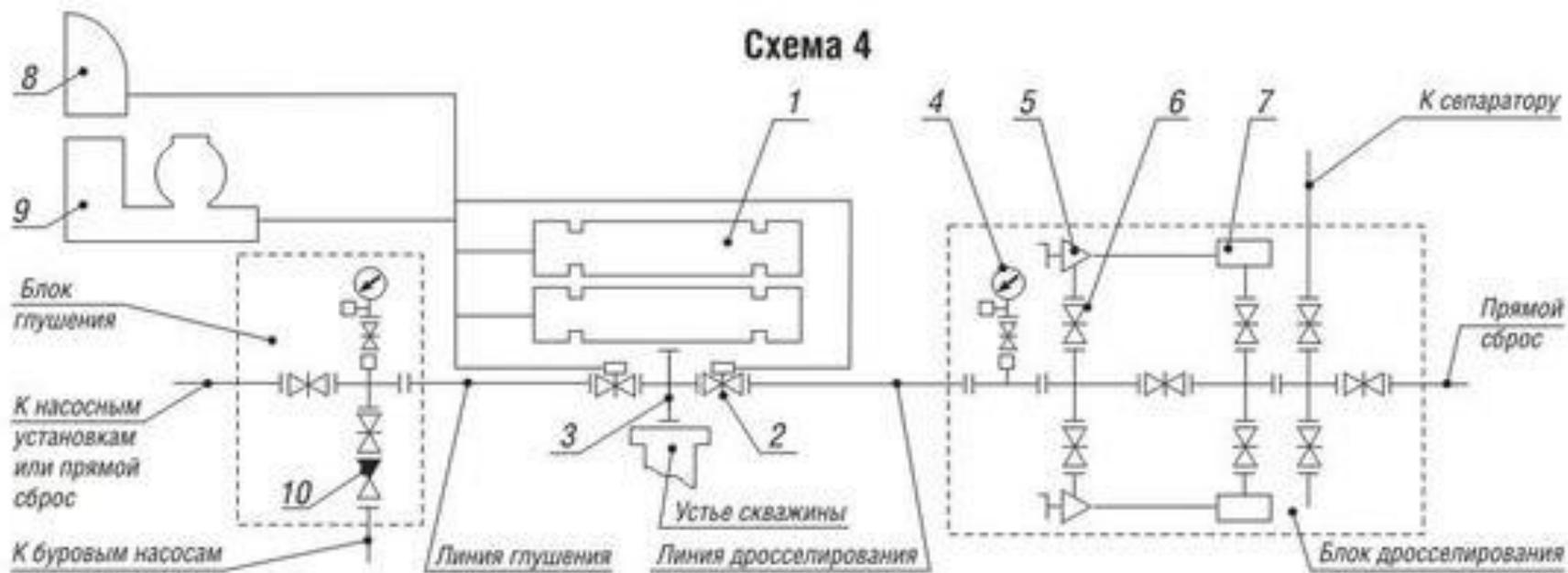
1. Плащечный превентор 2. Задвижка с гидравлическим управлением 3. Устьевая крестовина 4. Манометр с запорным и разрядным устройствами и разделителем сред 5. Дроссель регулируемый с ручным управлением 6. Задвижка с ручным управлением 7. Гаситель потока 8. Вспомогательный пульт 9. Станция гидравлического управления 10. Обратный клапан
