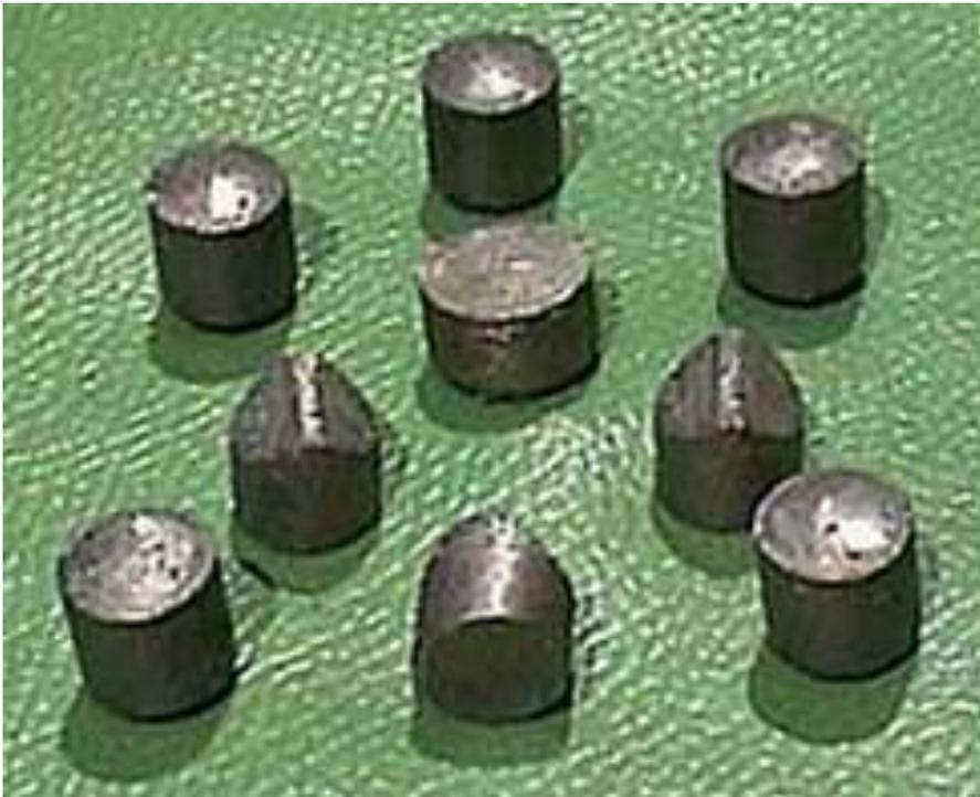
Сверхтвердый материал, разработанный ИСМ НАН Украины, уступает природным алмазам по износостойкости, но превосходит их по прочности. Изготавливается в виде штабиков или пластин любой формы.
