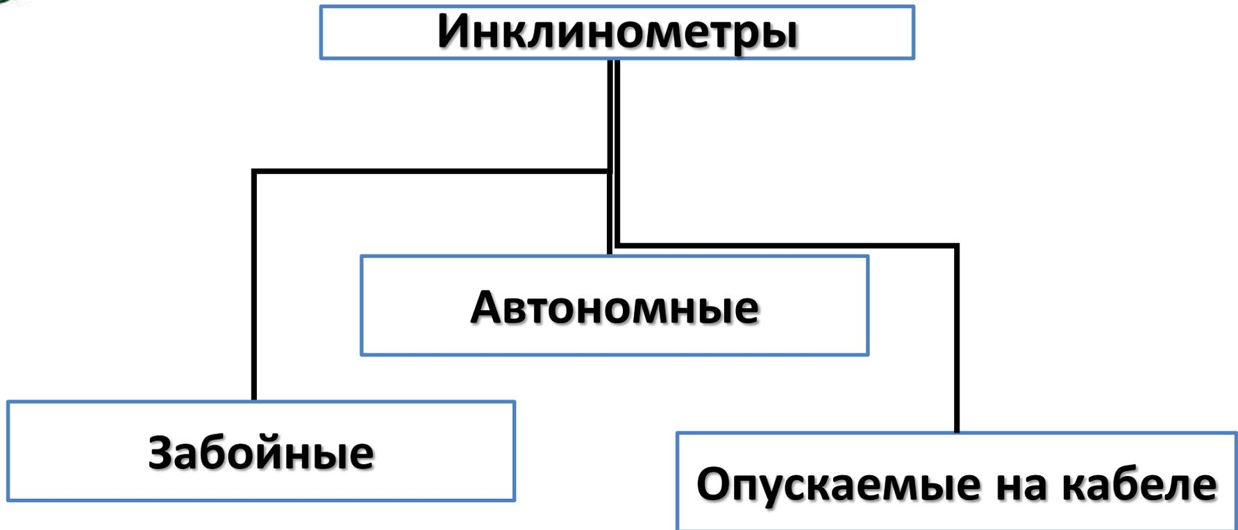
**Инклинометр** (от [лат.](#) *incline* — наклоняю и *...метр*) — [прибор](#), предназначенный для измерения угла наклона различных объектов, относительно гравитационного поля Земли. Помимо собственно величины угла наклона может измеряться его направление — [азимут](#).
