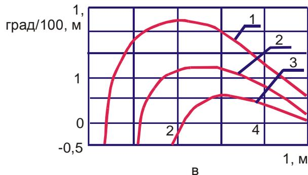
**в** - турбобур диаметром 240 мм, долото диаметром 295,3 мм, диаметр центратора 1-290 мм, 2-285 мм, 3-280 мм.
