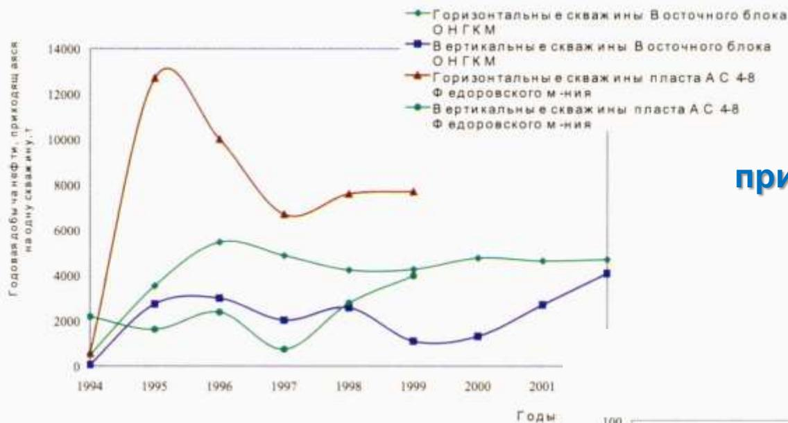
Годовая добыча нефти, приходящаяся на одну скважину по годам разработки
