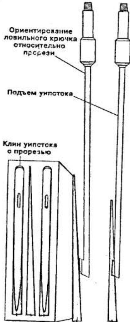
Дополнительное преимущество перед неизвлекаемыми открытыми клиньями - извлечение из скважины, что позволяет спустить необходимый инструмент в основной ствол и использовать клинья повторно.
