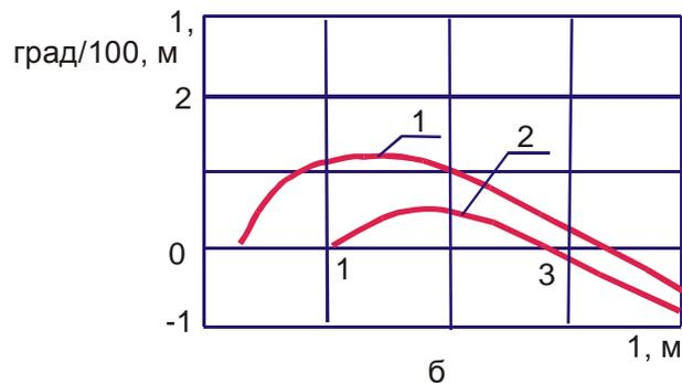
**б** - турбобур диаметром 195 мм, долото диаметром 215,9 мм, диаметр центратора 1-214 мм, 2-212 мм;
