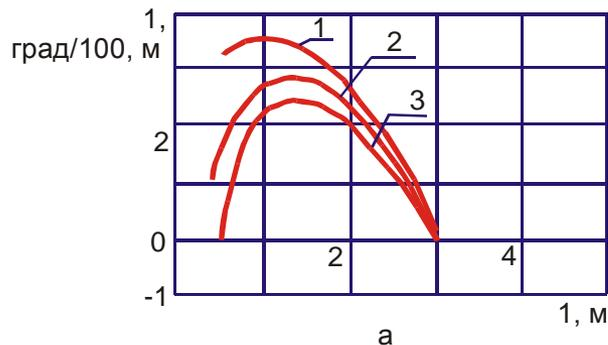
**а** - турбобур диаметром 172 мм, долото диаметром 215,9 мм, диаметр центратора 1-214 мм, 2-212 мм, 3-210 мм;
