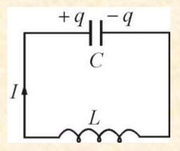
Колебания в контуре можно вызвать: либо зарядив конденсатор, либо вызвав в индуктивности ток (например, включив магнитное поле).
