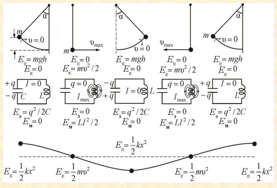
Если энергия конденсатора равна нулю, то энергия магнитного поля максимальна и наоборот...
