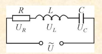
При включении переменного напряжения в цепи возникнет переменный ток, вызывающий на всех элементах цепи падения напряжения.
