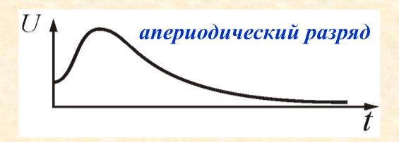
*Критическое сопротивление* - сопротивление контура, при котором колебательный процесс переходит в апериодический.
