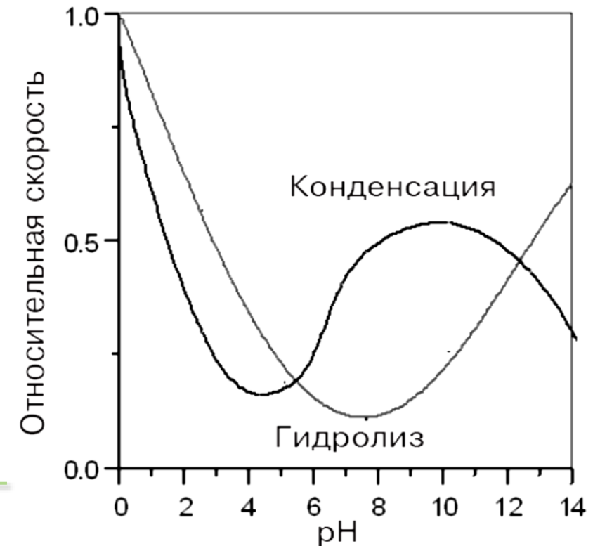
Рис. 4. Зависимость скорости гидролиза и конденсации тетраэтоксисилана от pH
