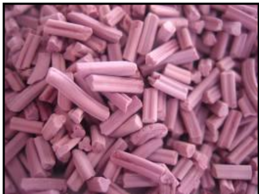
Катализатор ИК-ГО-1 для глубокой гидроочистки дизельных топлив (Институт катализа СО РАН)
