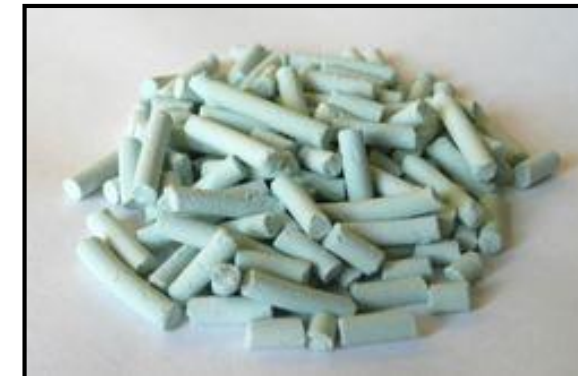
Катализатор гидроочистки дизельных фракций НК-233 (Новокуйбышевский завод катализаторов)
