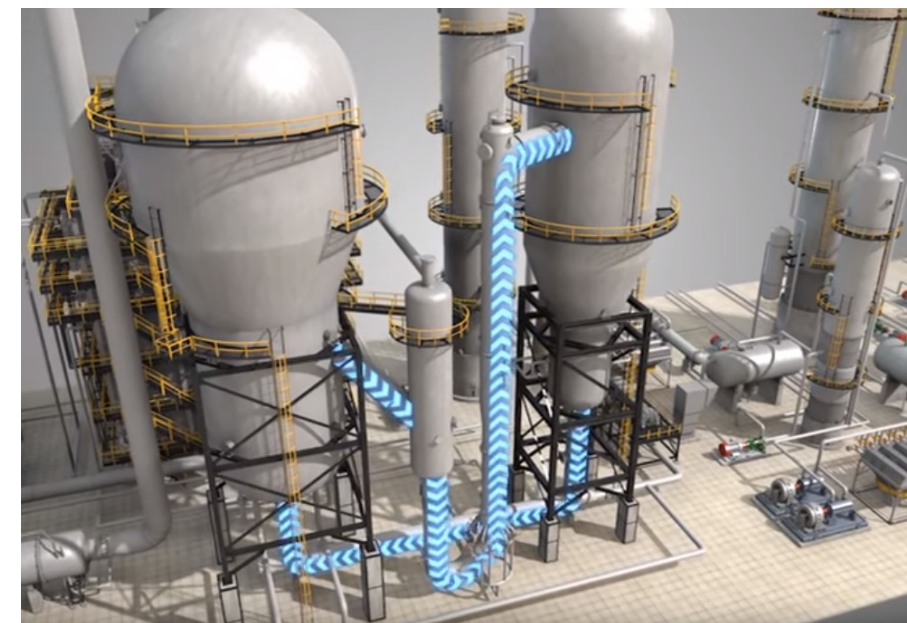
Реакторно-регенераторный блок установки каталитического крекинга
