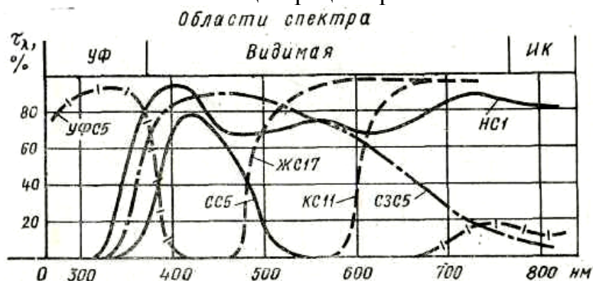
Рис. 2.7. Спектральные кривые пропускания \tau_\lambda = f(\lambda) цветных стекол, окрашенных молекулярными красителями в слое толщиной 2 мм
