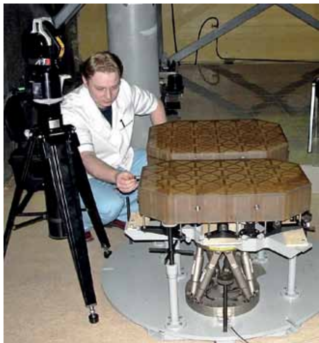
Рис. 9. Юстировка оптических элементов с внеосевой асферикой с использованием гексапода и лазерного трекера АПИТЗ
