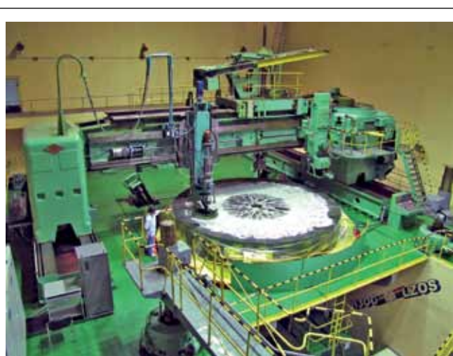
Рис. 7. Процесс полировки зеркала диаметром 6 метров БТА на станке КУ-168АДМ
