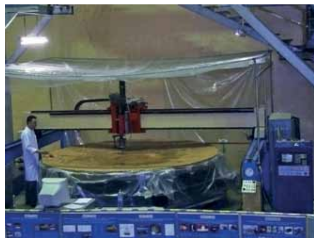
Рис.8. Финишная полировка зеркала ARIES диаметром 3700 мм на станке с компьютерным управлением Fig. 8. Final polishing of ARIES mirror with diameter of 3700 mm on computer managed machine
