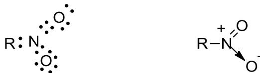
Эта структура показывает, что связи атома азота с двумя атомами кислорода неравноценны. Если одна из них является типичной двойной ковалентной связью, то во второй, помимо пары валентных электронов, образующих ковалентную связь, имеют место разноименные заряды на атомах азота и кислорода. Таким образом, связь N–O в нитрогруппе является, с одной стороны, ковалентной, а с другой – ионной. Такие связи и называют *семиполярными* (по-русски – полуполярными), или *донорно-акцепторными*.
