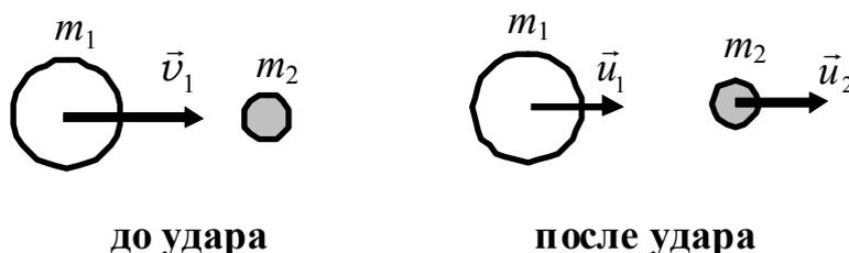
б)  $m_1 < m_2$ . После удара направление движения первого шара изменится – шар отскакивает обратно. Второй шар движется в ту сторону, в которую двигался первый шар до удара.
