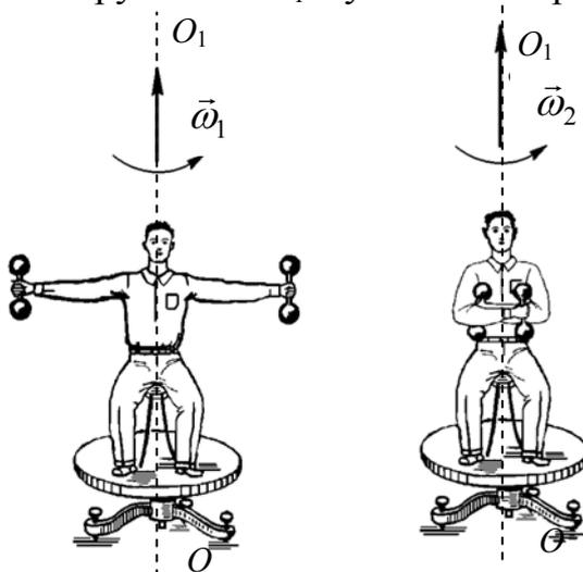
Если человек прижмет гантели к себе, то момент инерции системы уменьшится. Поскольку момент внешних сил (сил тяжести и реакции подшипников) относительно оси  $OO_1$  равен нулю, то момент импульса системы относительно оси  $OO_1$  сохраняется:
