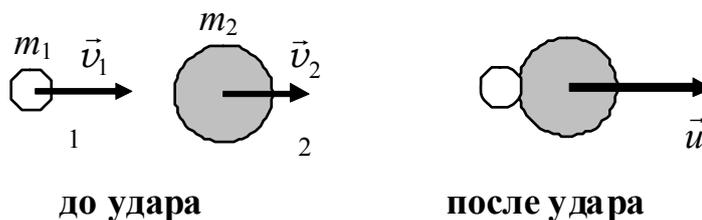
Имеем шары массами  $m_1$  и  $m_2$ , их скорости соответственно равны  $\vec{v}_1$  и  $\vec{v}_2$ . В момент удара шары деформируются, но эта деформация не исчезает и шары после удара двигаются с одинаковой скоростью.
