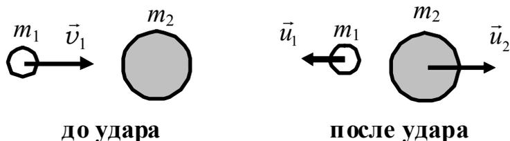
Чем больше разница в массах, тем меньшую энергию передает малый шар большому. При  $m_1 \ll m_2$   $u_2 = 0$ . Например, при абсолютно упругом ударе электрона с атомом электрон полностью сохраняет кинетическую энергию.
