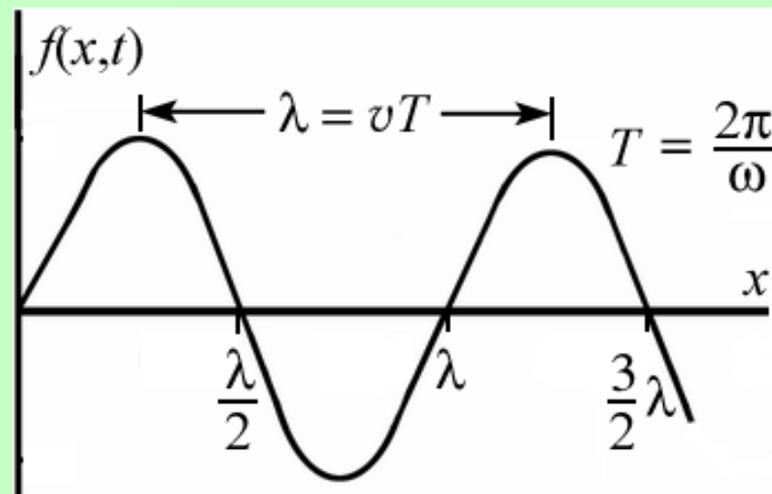
В среде без дисперсии скорость распространения синусоидальной волны без изменения ее формы есть *скорость распространения поверхности постоянной фазы*, или *фазовая скорость*.
