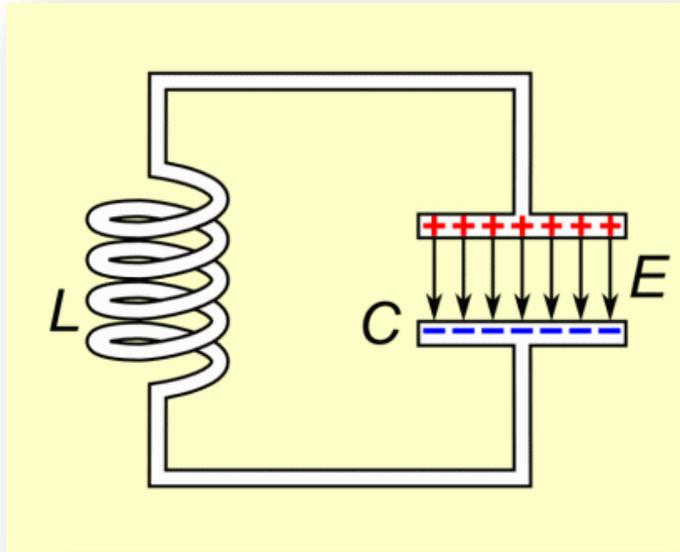
цепь, состоящая из катушки и конденсатора, соединенных последовательно, омическое сопротивление пренебрежимо мало.
