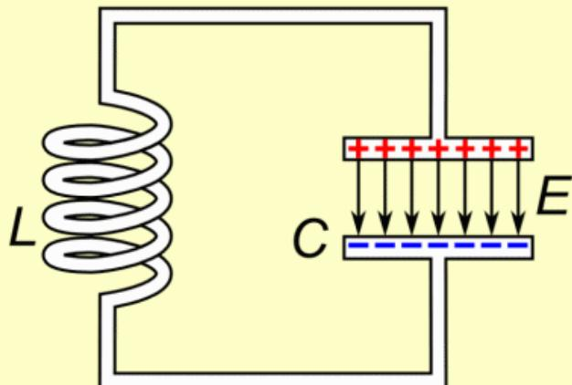
цель, состоящая из катушки и конденсатора, соединенных последовательно, омическое сопротивление пренебрежимо мало.
