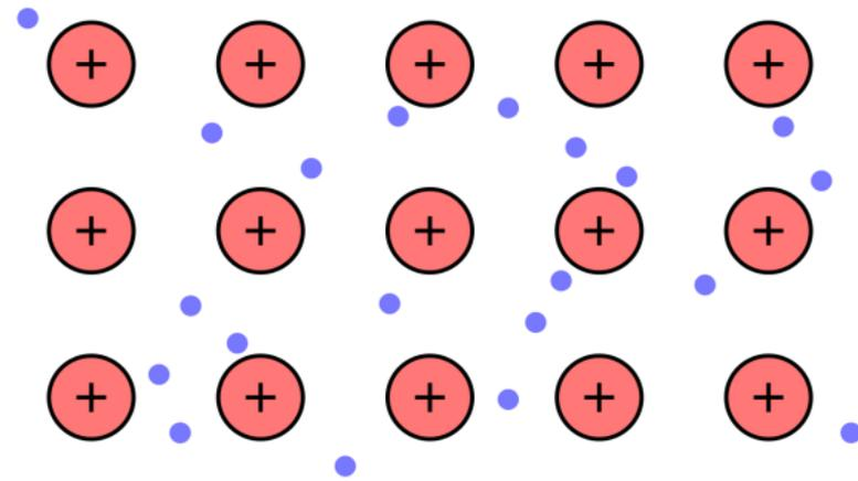
4. **Нормировка:** если обнулить потенциальную энергию электрона вне кристалла, то внутри кристалла его потенциальная энергия отрицательна: электрон находится внутри кристалла в потенциальной яме.
