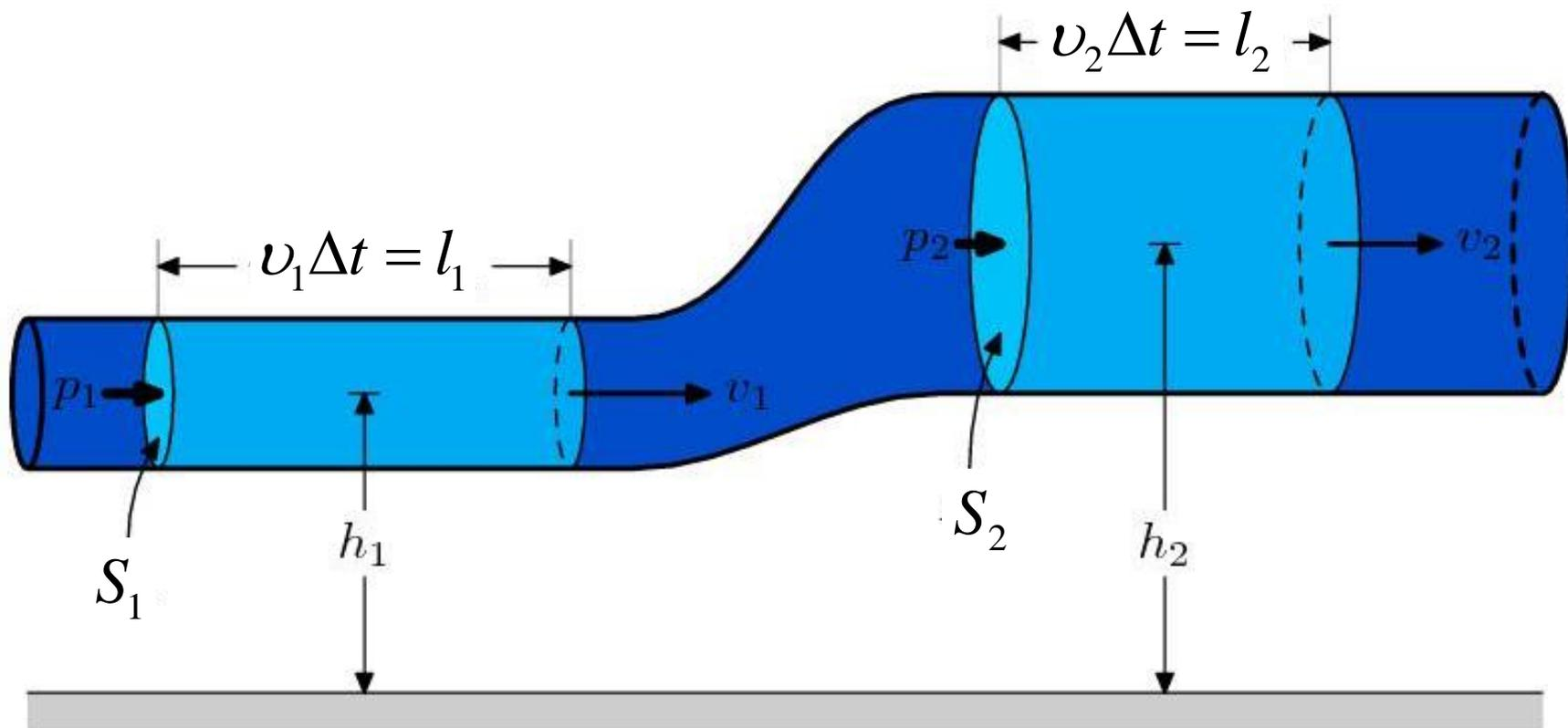
Выделим в стационарно текущей идеальной жидкости трубку тока, ограниченную сечениями  $S_1$  и  $S_2$ , по которой слева направо течет жидкость
