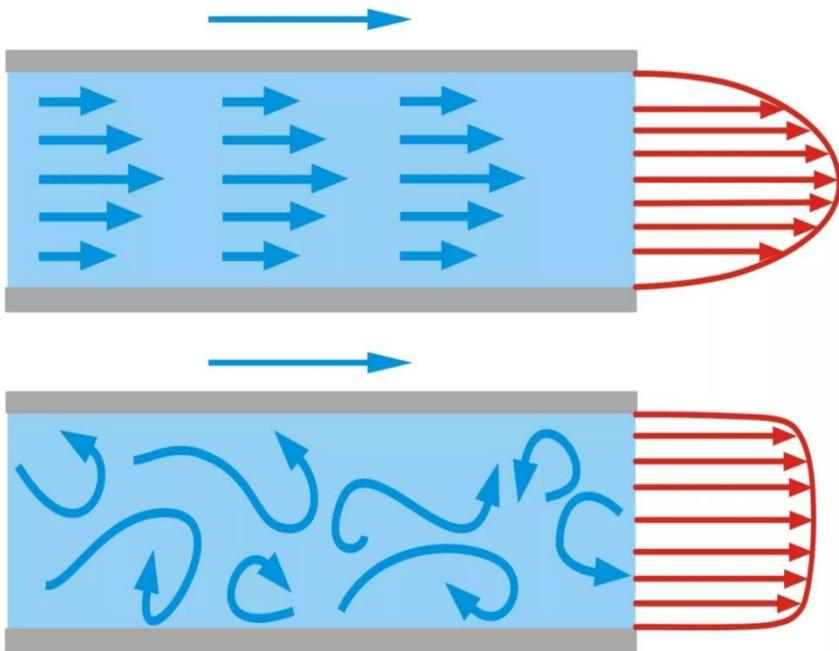
**Ламинарное** (слоистое) течение – течение, при котором вдоль потока каждый выделенный тонкий слой скользит относительно соседних, не перемешиваясь с ними.
