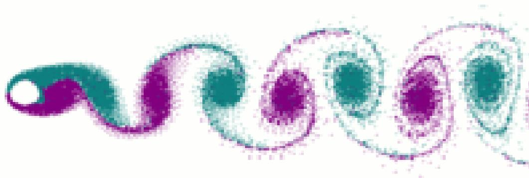
Вихревая дорожка при обтекании цилиндра
