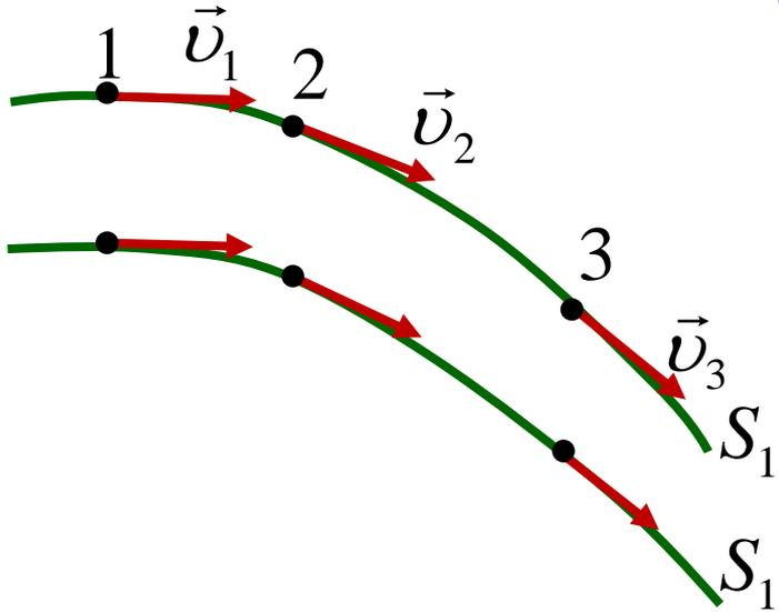
– воображаемая линия, проведённая в потоке таким образом, что в каждой её точке направление скорости совпадает с касательной к этой линии.
