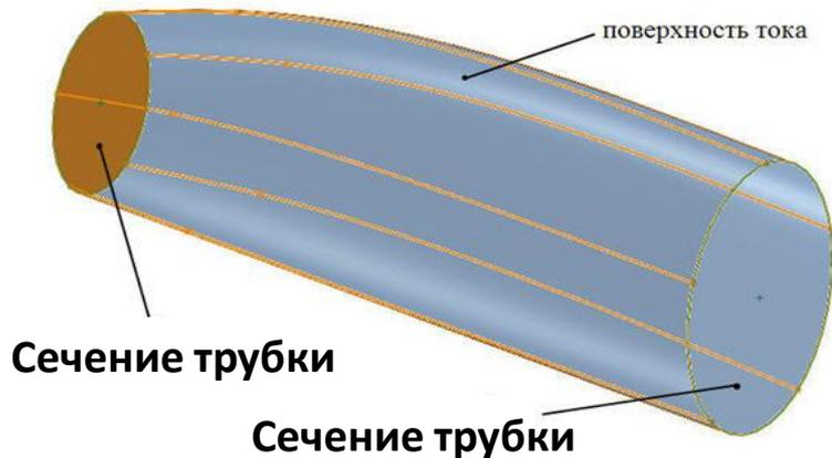
**Жидкость внутри трубки тока, не может покинуть ее пределы**
