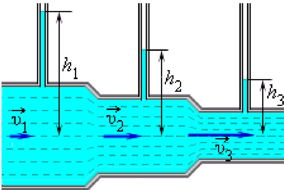
Давление в жидкости, текущей по горизонтальной трубе переменного сечения, больше в тех сечениях, где скорость движения меньше, и наоборот, меньше в тех сечениях, в которых скорость больше
