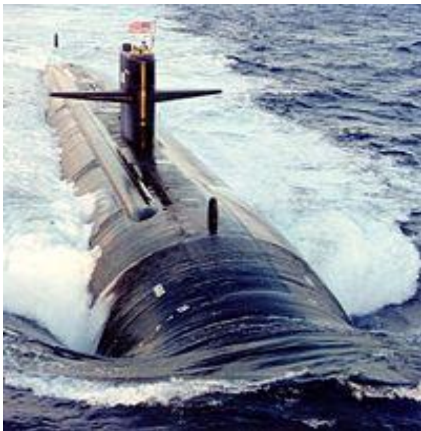
Ламинарное (на переднем плане) и турбулентное течение вокруг субмарины «Лос-Анджелес»
