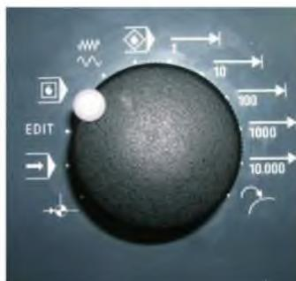
Рис. 9. Селектор режимов токарного станка **TURN 55**
