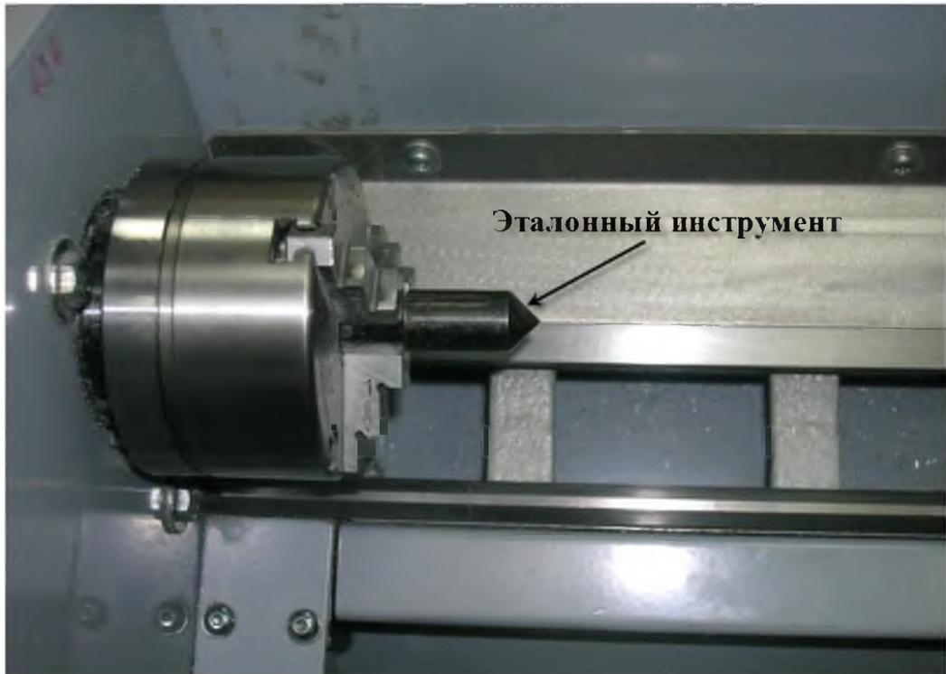
**Рис. 3.** Установка эталонного инструмента-конуса в трехлапчатый патрон
