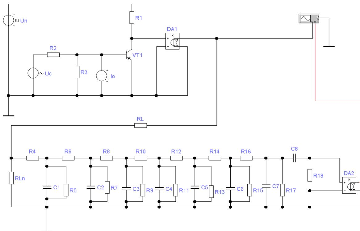
Рис. 9. Модель системы телеизмерения с амплитудно-импульсной
