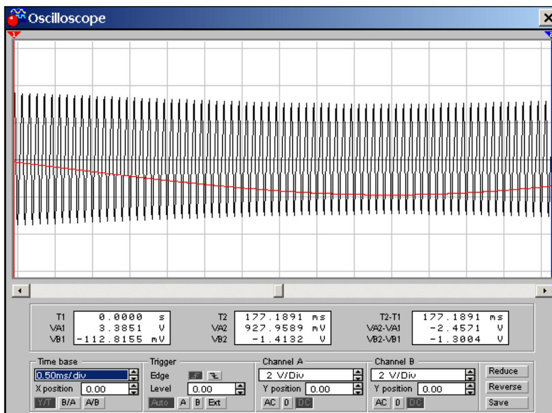
Рис. 2. Форма АМ-колебаний и сигнала на выходе приемника
