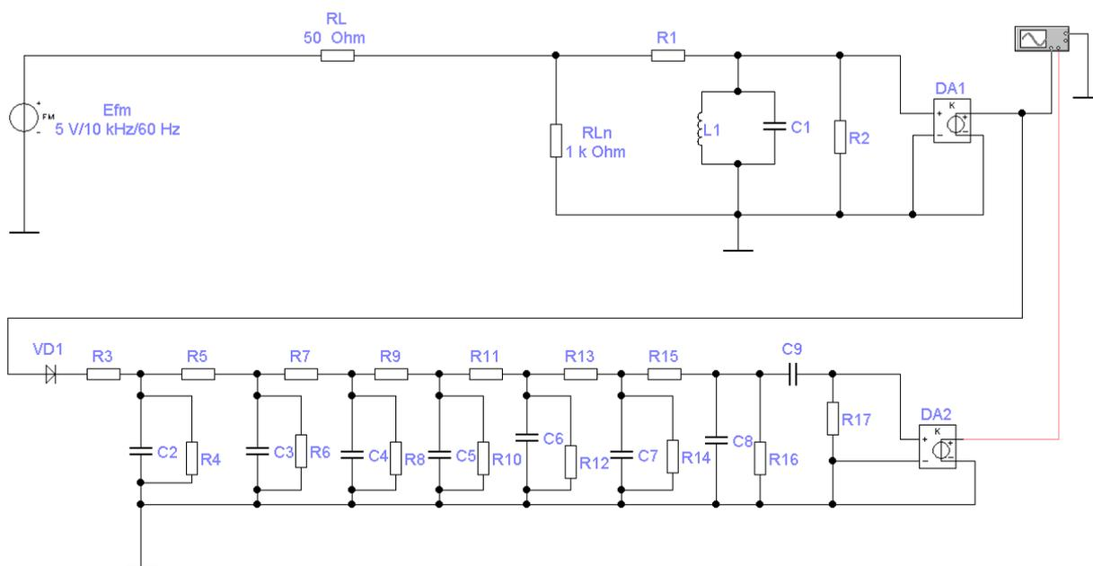
Рис. 7. Модель системы телеизмерения с частотной модуляцией
