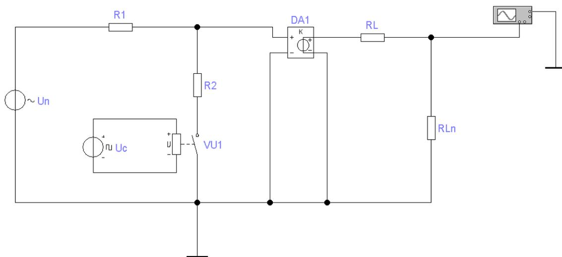
Рис. 6. Модель передатчика для системы с амплитудной манипуляцией представленную на рис. 6.
