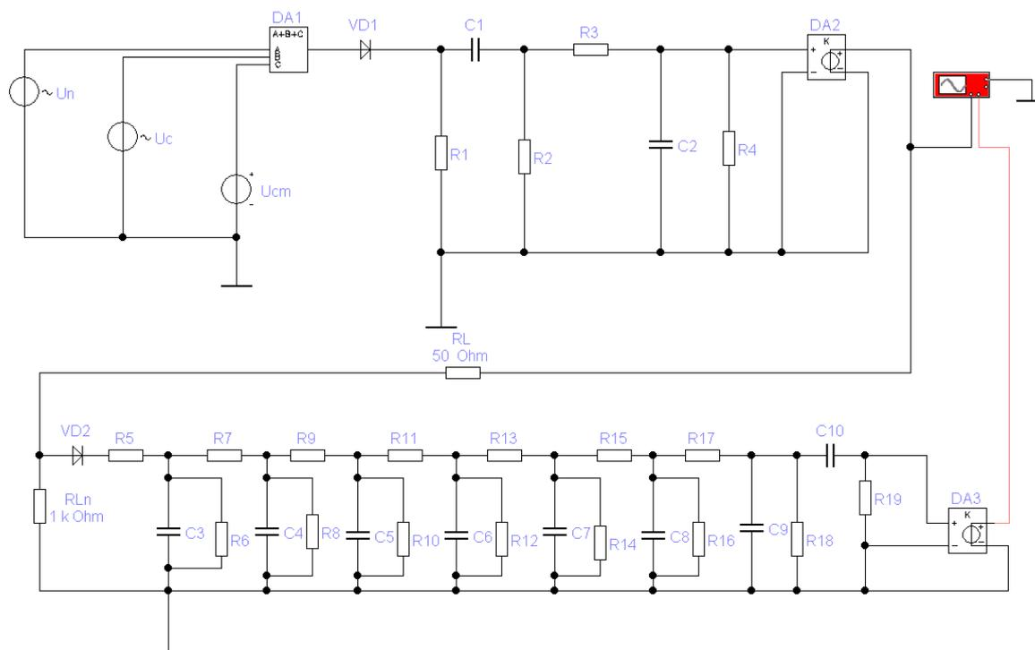
Рис. 1. Модель системы телеизмерения с амплитудной модуляцией
