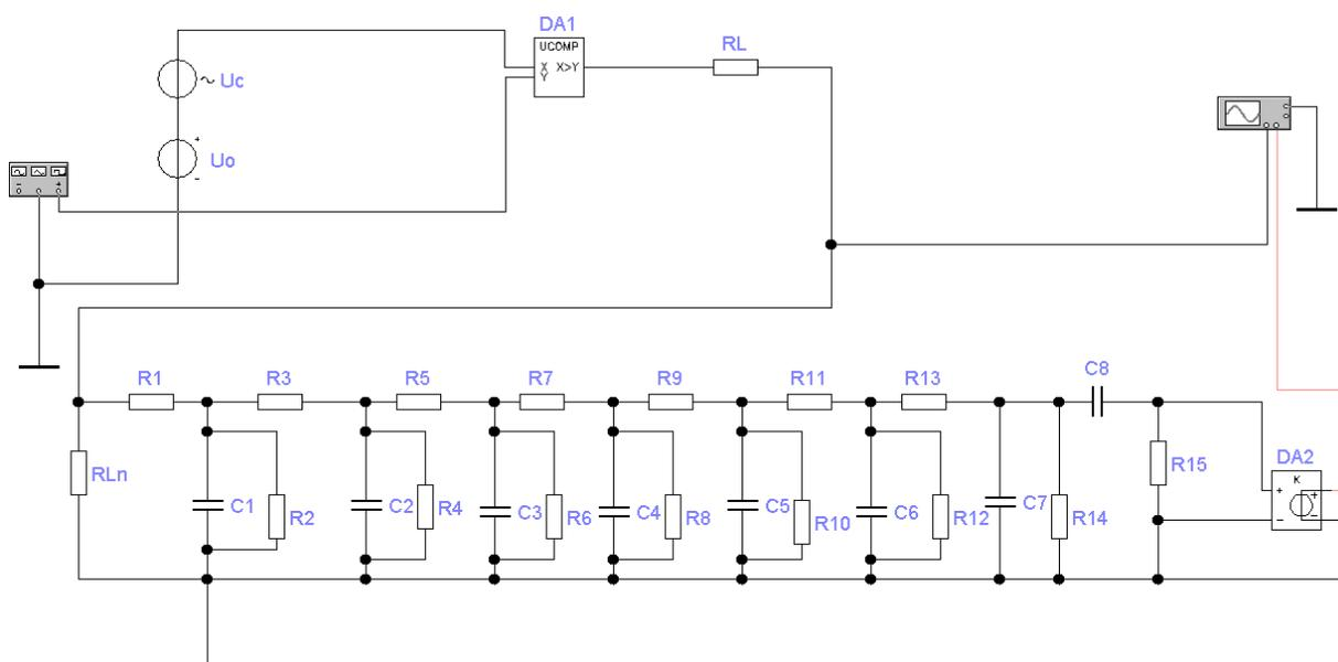
Рис. 11. Модель системы телеизмерения с широтно-импульсной модуляцией
