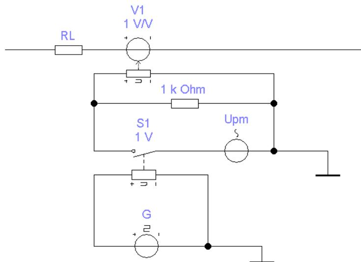
Рис. 5. Генератор импульсной помехи в
