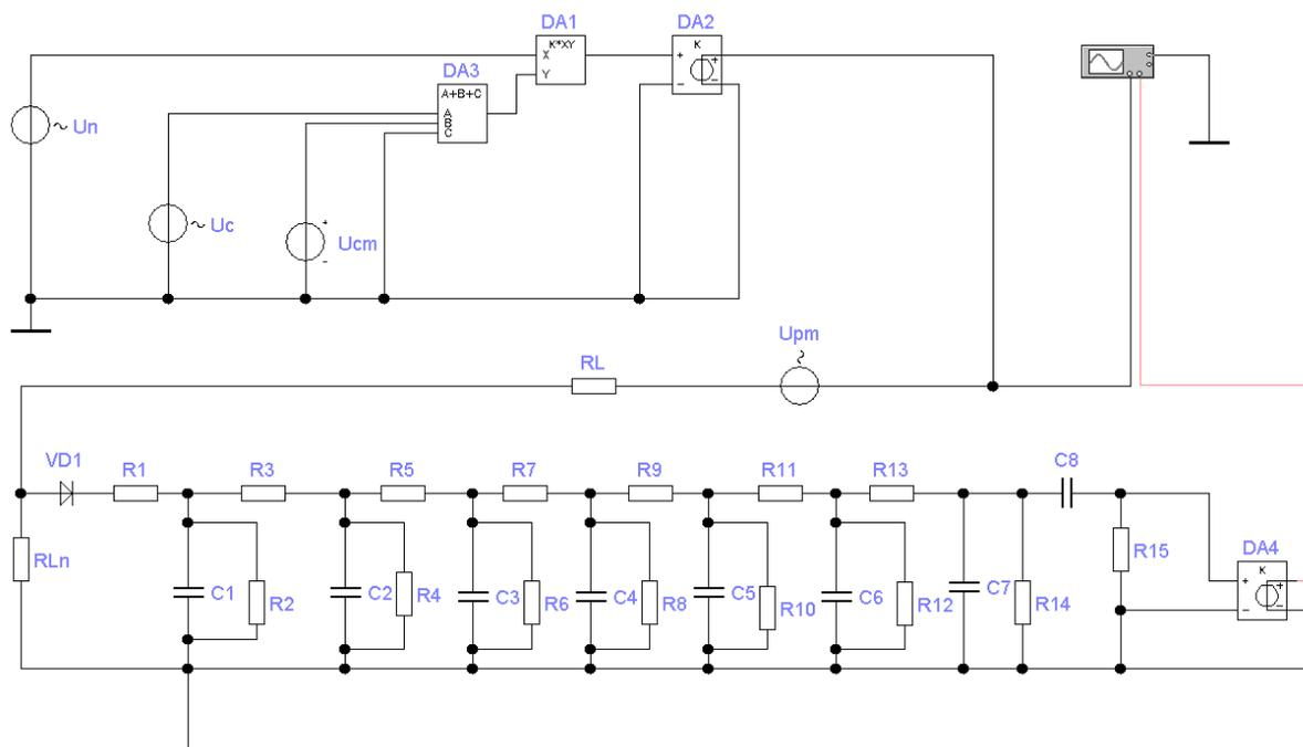
Рис. 3. Модель системы телеизмерения с амплитудной модуляцией
