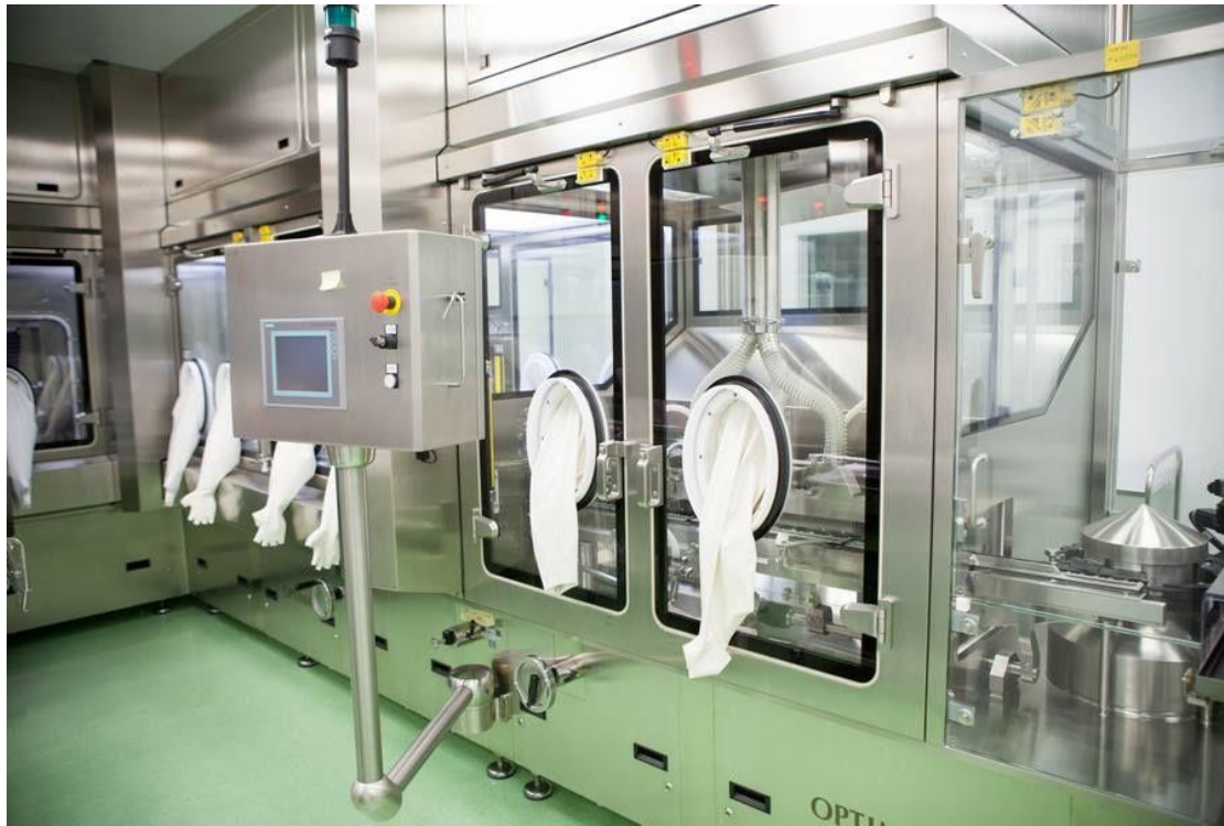
Рис. 20. Применение изоляторных технологий компании JANSSEN в производстве лекарственного препарата «Велкейд» на ОАО «Фармстандарт»
