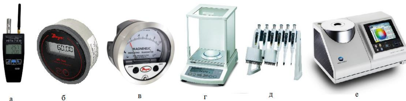
Рис. 21. Средства измерений, используемые в лаборатории: а – измеритель влажности и температуры, б, в – дифференциальные манометры, г – весы лабораторные, д – дозаторы механические, е – спектрофотометр
