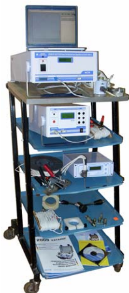
Рис. 2.8. Комплекс безразборного контроля высоковольтных выключателей ИКВ-01
