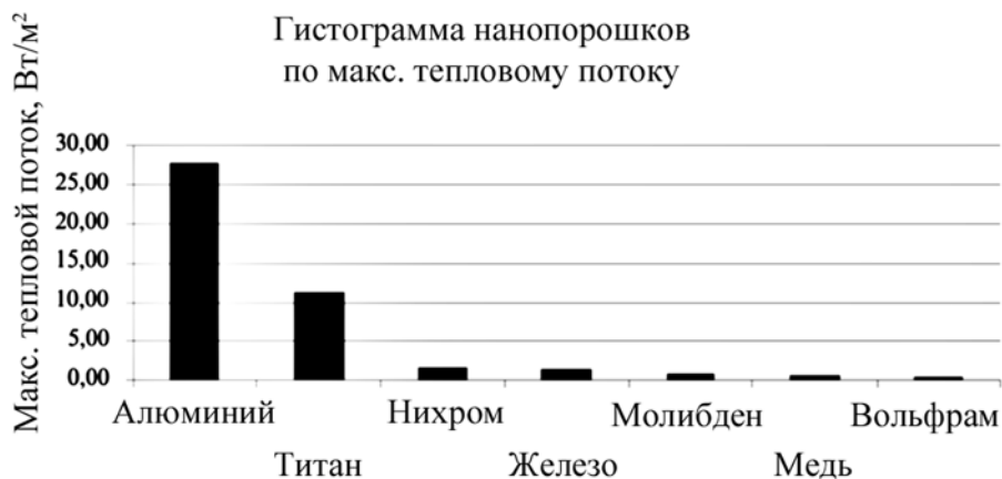
Рис. 8. Максимальный тепловой поток при горении различных нанопорошков металлов
