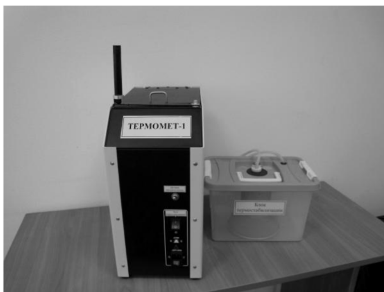
Рис. 4. Установка для определения теплового потока при горении нанопорошков металлов «ТЕРМОМЕТ-1»
