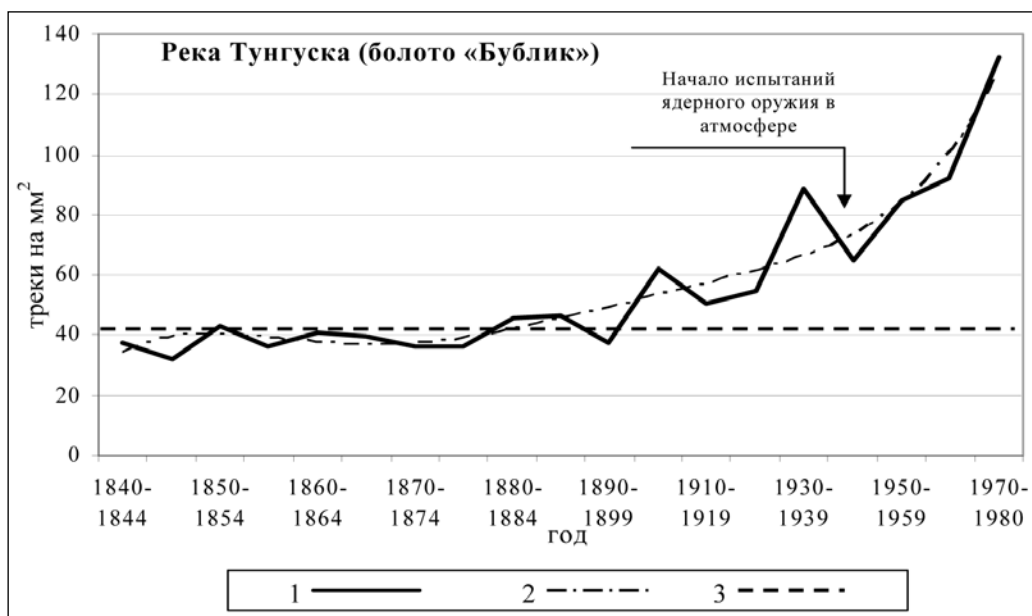
Рис. 10. Изменение глобального фона делящихся радионуклидов ( U^{235} , Pu , At и др.) за последние 150 лет (по результатам f -радиографии колец деревьев).
