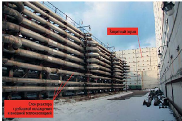
Реактор полимеризации этилена высокого давления – трубопровод длиной 3 км (3 зоны по 1 км каждая)
