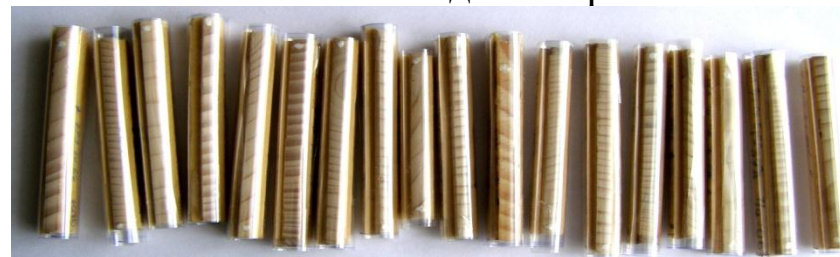
Образцы, покрытые трехкратным слоем лавсановой пленки
