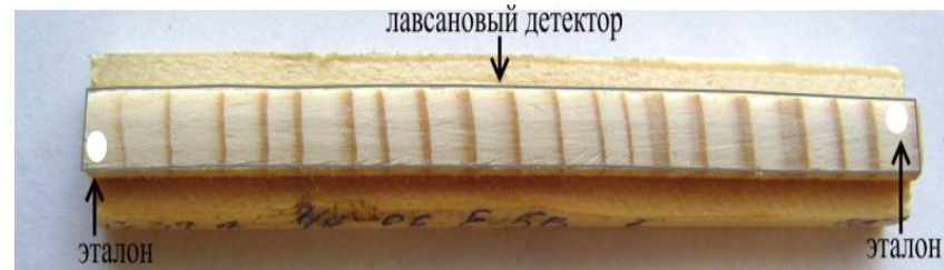
Образец, на поверхность которого нанесен урановый эталон и лавсановый детектор
