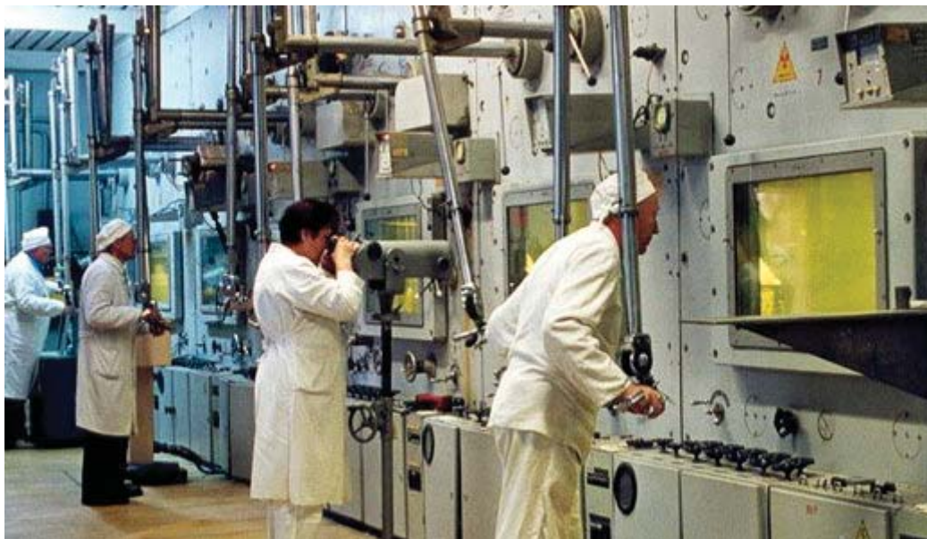
Рис. 43. Защитная комната для работы с манипуляторами
