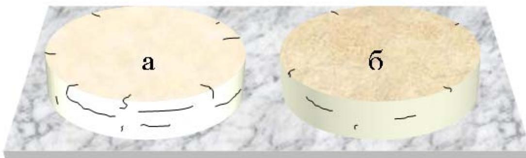
Рис. 3.34. Характер макродефектов в образцов керамики из нанопорошка ЦТССт5 после спекания.
