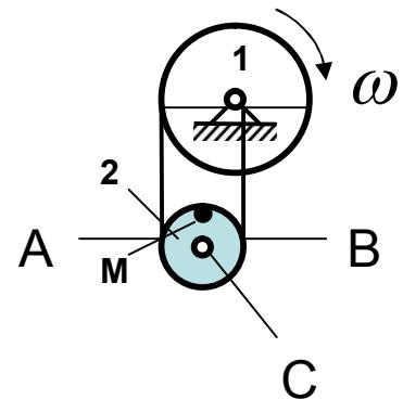
Дано:  $\omega = \text{const}; \quad r_1 = 2r.$
