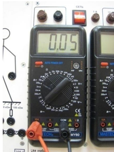
Рис. 8. Подключение мультиметра для измерения тока
