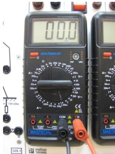
Рис. 9.6. Подключение мультиметра для измерения напряжения
