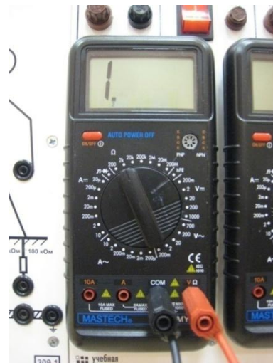
Рис. 9.7. Подключение мультиметра для измерения сопротивления
