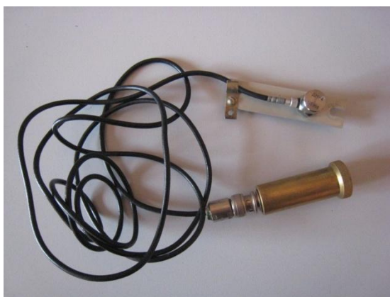
Рис. 7.4. Вибропреобразователь с пластиной, проводом и эквивалентом микрофонного капсуля.
