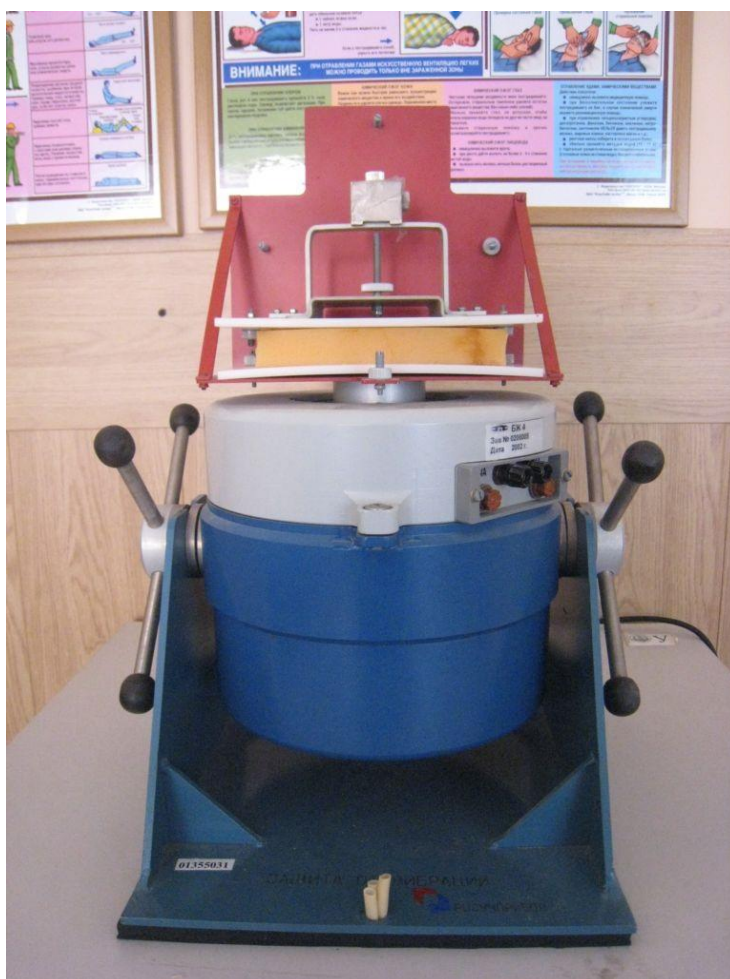
Рис. 7.1. Внешний вид вибростенда
