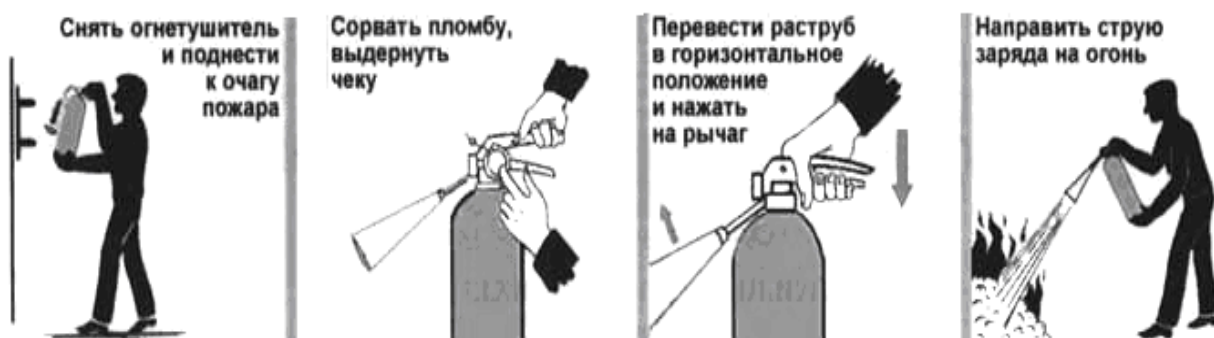
Рис. 2.7. Приведение в действие ручного углекислотного огнетушителя
