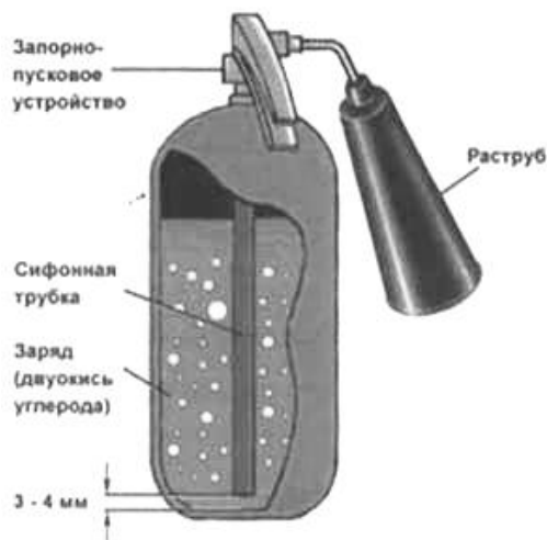
Рис. 2.6. Конструкция углекислотного огнетушителя
