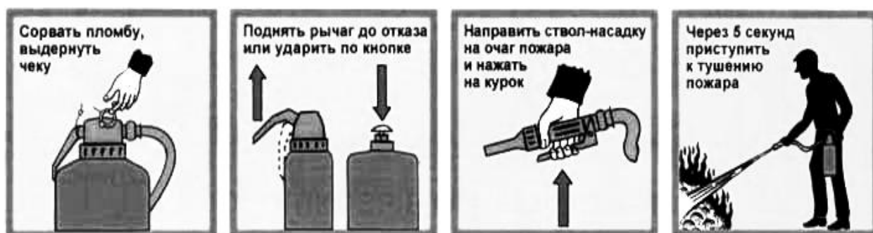
Рис. 2.13. Приведение в действие порошкового огнетушителя со встроенным источником давления
