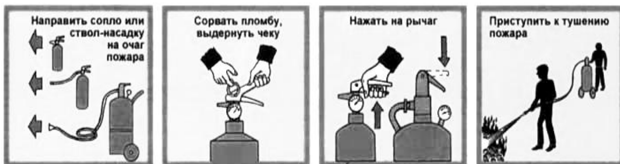
Рис. 2.12. Приведение в действие порошкового огнетушителя закачного
