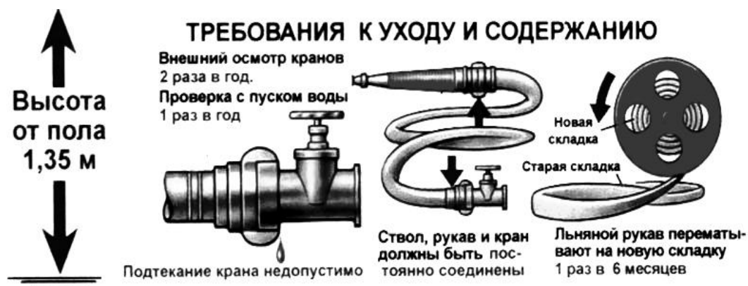
Рис. 2.4. Требования к уходу и содержанию пожарных кранов
