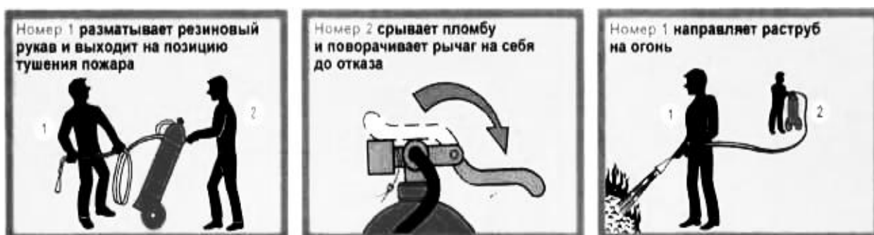
Рис. 2.8. Приведение в действие передвижного углекислотного огнетушителя
