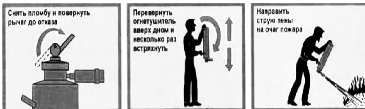
Рис. 15. Приведение в действие химического пенного огнетушителя
