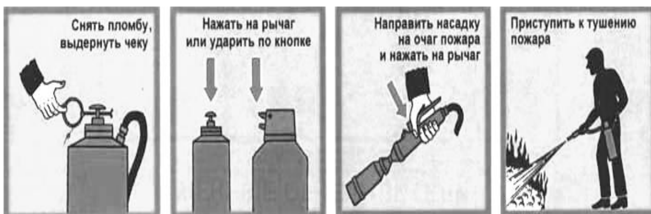
Рис. 2.17. Приведение в действие воздушно-пенного огнетушителя
