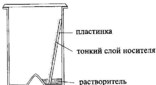
Рис 3.1. Хроматографическая камера для тонкослойной хроматографии
