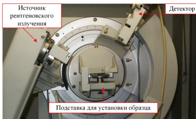
Рис. 1.33. Аппарат XRD с указанием расположения источника, образца и детектора (Siemens D5005)
