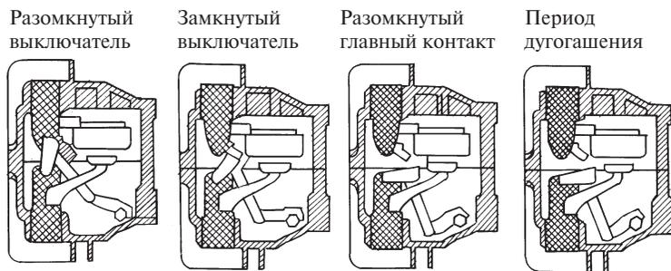
**Рис. 6.16. Схема работы элегазового выключателя с гашением дуги вращением**
