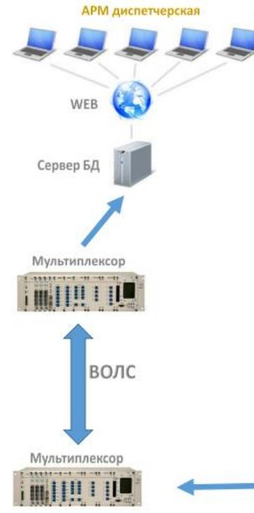
*Структурная схема системы мониторинга Almasense*
