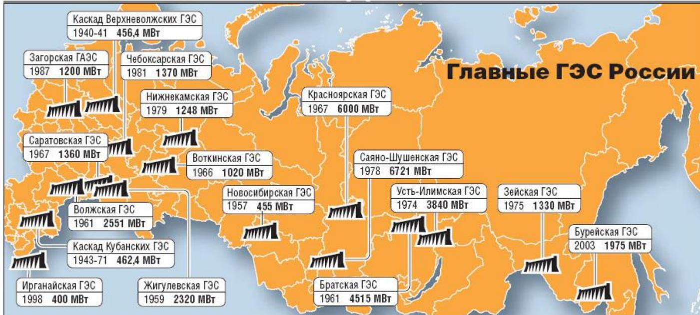
ГЭС строятся в тех местах, где можно построить плотину и водохранилище большого объема, т. е., как правило, вдали от потребителей. ГЭС целесообразно проектировать на большую мощность, а значит, выдача электроэнергии производится на высоких и сверхвысоких напряжениях, а структура станции – блочная
