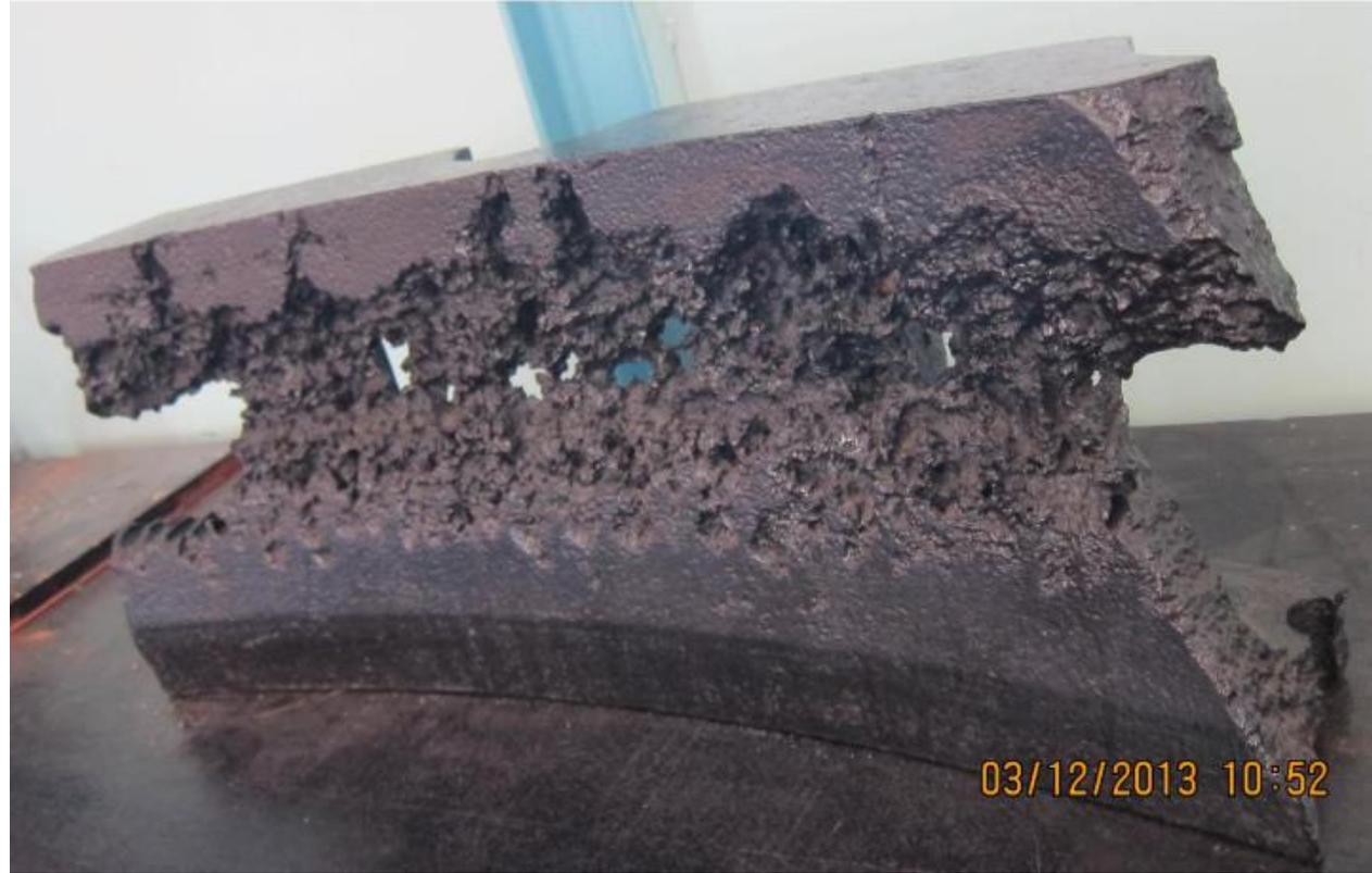
*Кавитационное разрушение (эрозия) металла*
