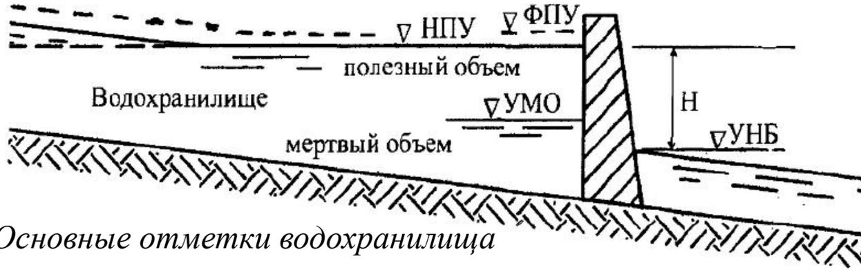
**Водохранилище** — искусственный водоём, образованный, как правило, в долине реки водоподпорными гидротехническими сооружениями для накопления и хранения воды в целях её дальнейшего использования для выработки эл.энергии на ГЭС, для орошения полей (ирригации), для водоснабжения потребителей и т.д.
