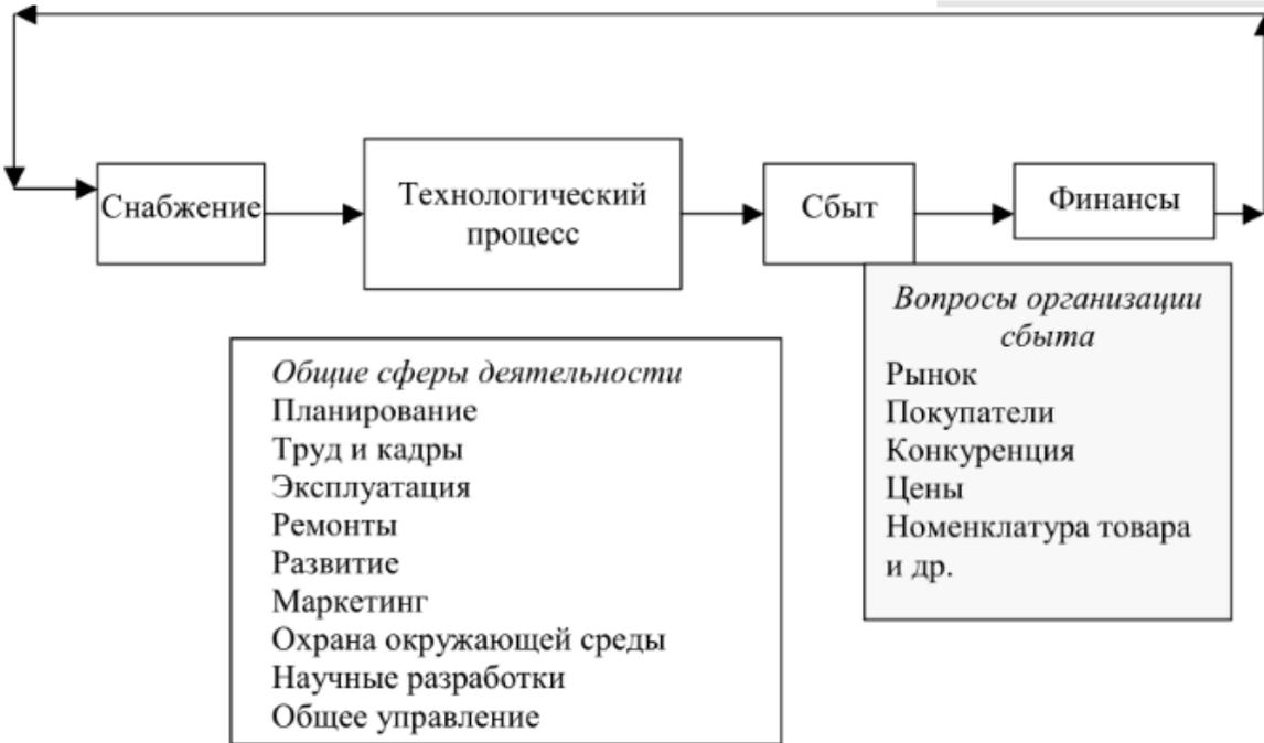
*Схема производственного процесса энергообъекта*
