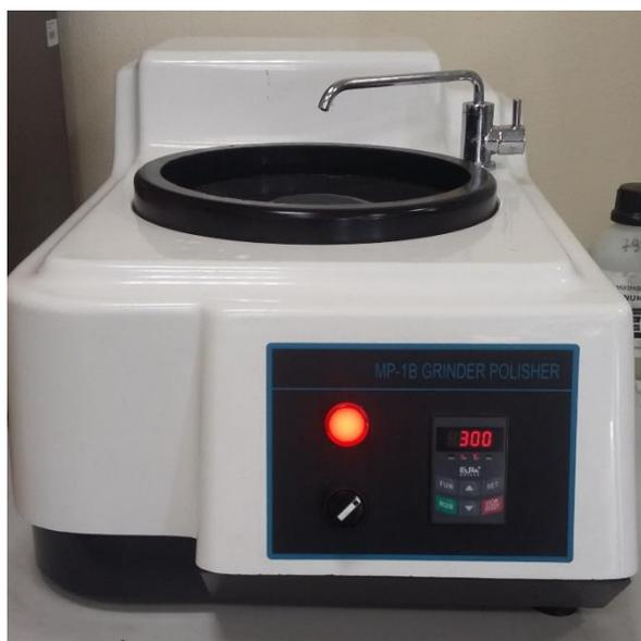
**Рисунок 1.1** – Полировально-шлифовальная машина МР-1В.
