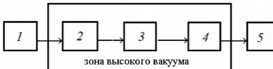
**Рисунок 4.1** – Блок-схема масс-спектрометра: 1 – система ввода материала образца; 2 – источник ионизации с ускорителем ионов; 3 – масс-анализатор (устройство разделения ионов по массовому числу); 4 – детектор; 5 – регистрирующее устройство.
