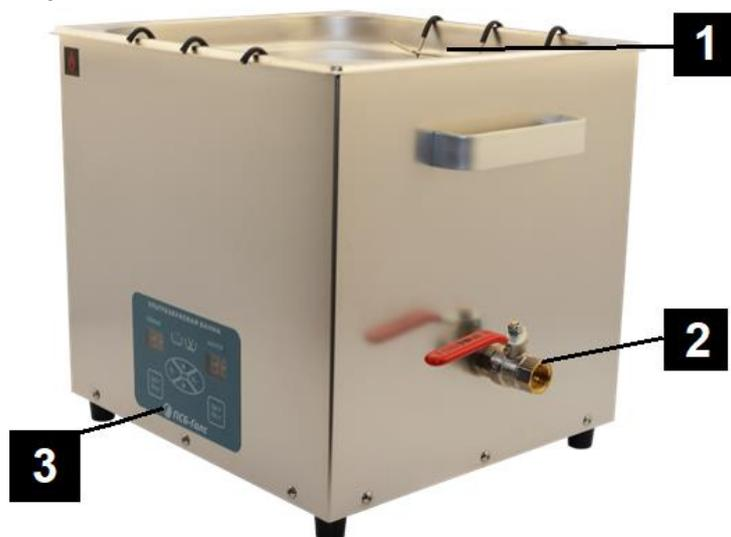
**Рисунок 2.3** – Ультразвуковая ванна ПСБ-18035-05: 1 - рабочий объём ванны; 2 - сливной кран; 3 - панель управления прибором.
