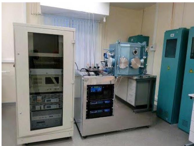
**Рисунок 3.1**– Внешний вид экспериментальной ионно-плазменной установки.
