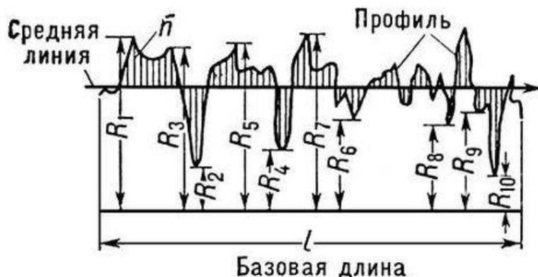
**Рисунок 1.2** – Схематичное изображение профиля поверхности и измеряемые параметры.
