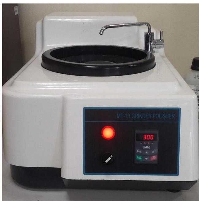
Рисунок 1 – Полировально-шлифовальная машина МР-1В.
