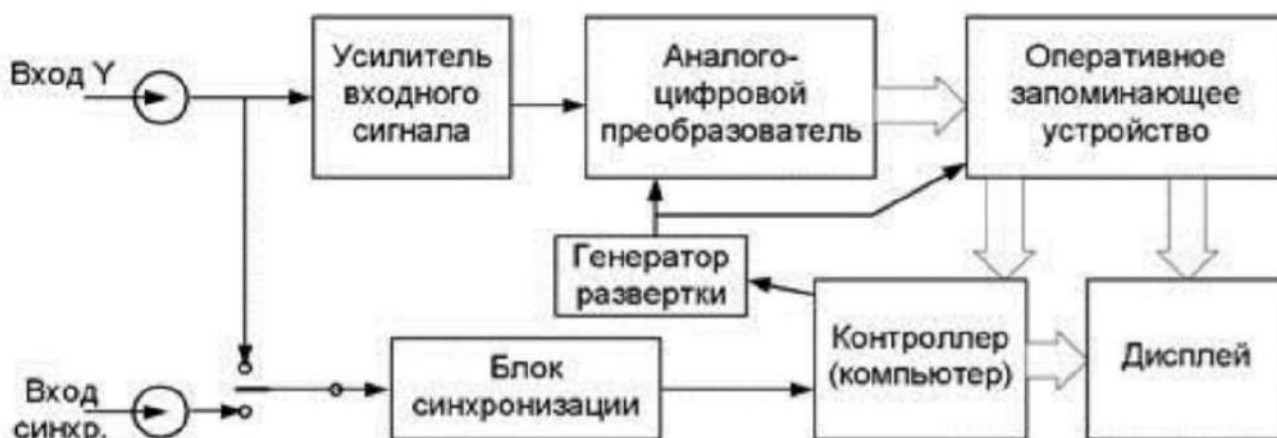
Рисунок 1.4 – Упрощенная структурная схема цифрового осциллографа.
