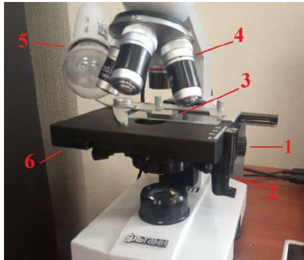
Рисунок 3.4 – Расположение образца под микроскопом: 1 – регулировка фокусного расстояния; 2 – регулировка положений по осям X и Y; 3 – образец; 4 – окуляр микроскопа; 5 – лампа; 6 – стол для размещения образцов.
