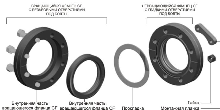
Соединения CF используются для изготовления сверхвысоковакуумных камер и магистралей (предельное остаточное давление до  $10^{-13}$  Торр) и могут применяться в широком температурном диапазоне (от  $-200$  °C до  $450$  °C). В состав соединения CF входят 2 идентичных по конструкции фланца CF, медная прокладка (толщиной 2 мм), комплект болтов и гаек (или установочных пластин).
