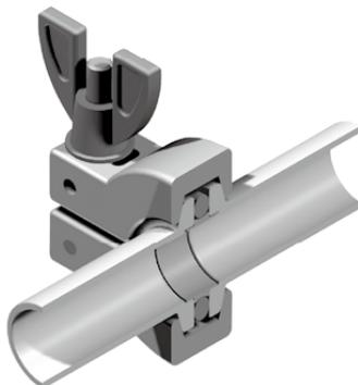
При соединении **двух фланцев ISO-KF** сжатие расположенного между ними уплотнительного кольца и, соответственно, их вакуумно-плотное соединение, достигается за счет шарнирных хомутов, обеспечивающих равномерное усилие на внешние, скошенные под  $15^\circ$  стороны ISO-KF фланцев.
