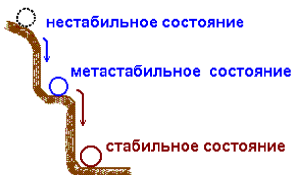
Рис. 8.15. Схема, иллюстрирующая вероятность образования графита и цементита
