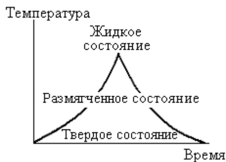
Рис. 2.3. Кривая нагрева-охлаждения аморфных веществ
