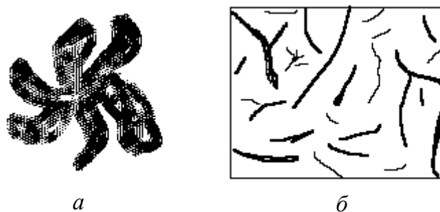
Рис. 8.17. Кристалл графита ( а ) и выделения графита на нетравленном шлифе ( б )
