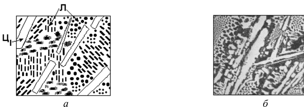
Рис. 8.12. Схема (а) и фотография (б) микроструктуры заэвтектического белого чугуна
