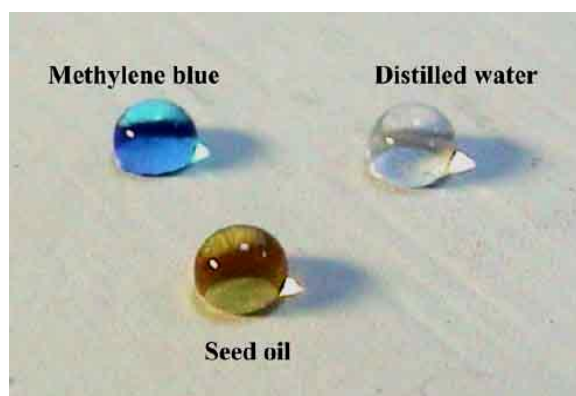
Рис. 17.12. Покрытие на основе наночастиц оксида титана:
