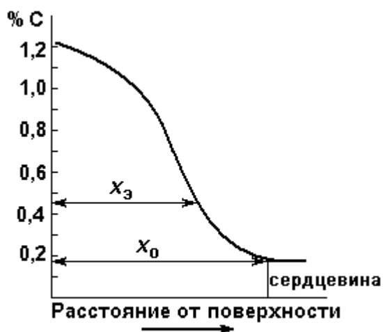
Рис. 10.1. Распределение углерода по сечению цементованных деталей
