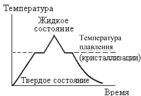
Рис. 2.2. Кривая нагрева-охлаждения кристаллических веществ
