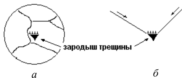
Рис. 4.5. Схема образования зародыша трещины при скоплении дислокаций перед границей зерна (а) и при пересечении плоскостей скольжения дислокаций (б)
