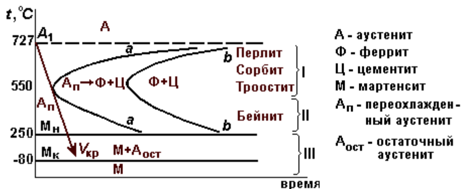
Рис. 9.4. Диаграмма изотермического превращения аустенита для стали с 0,8 % С
