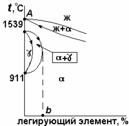
Рис. 8.19. Диаграмма состояния железо-легирующий элемент (Cr, V)
