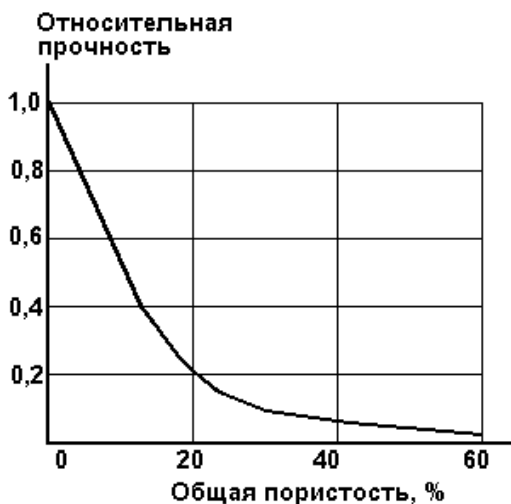
Рис. 16.1. Влияние пористости на прочность керамики
