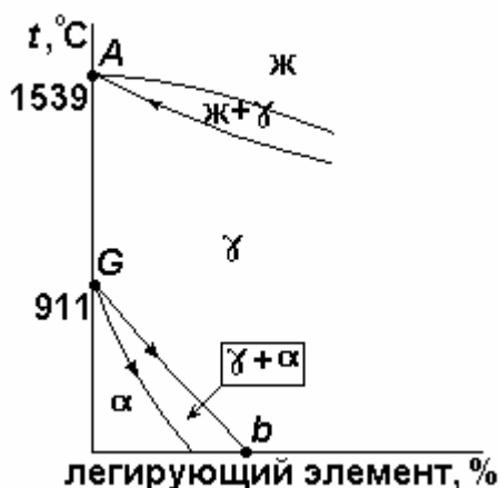
Рис. 8.18. Диаграмма состояния железо-легирующий элемент (Ni, Mn, Co)
