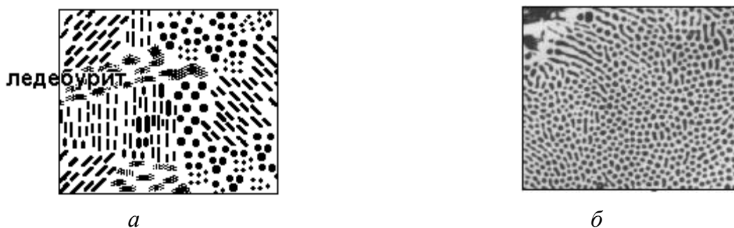
Рис. 8.11. Схема (а) и фотография (б) микроструктуры эвтектического белого чугуна
