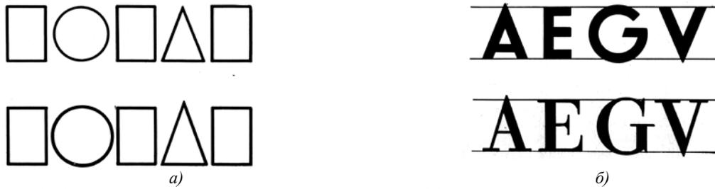
Рис. 2.10. Превышение высоты букв для нивелирования эффекта иррадиации (а – геометрическая схема, б – необходимое превышение букв при полужирном гротеске и при классическом античном шрифте).
