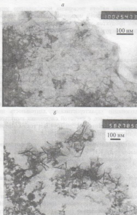
Рис. 1. Типичные ЭМ фотографии твердых продуктов ЭР в воде. Загрузка: а – алюминиевая, б – железная.
