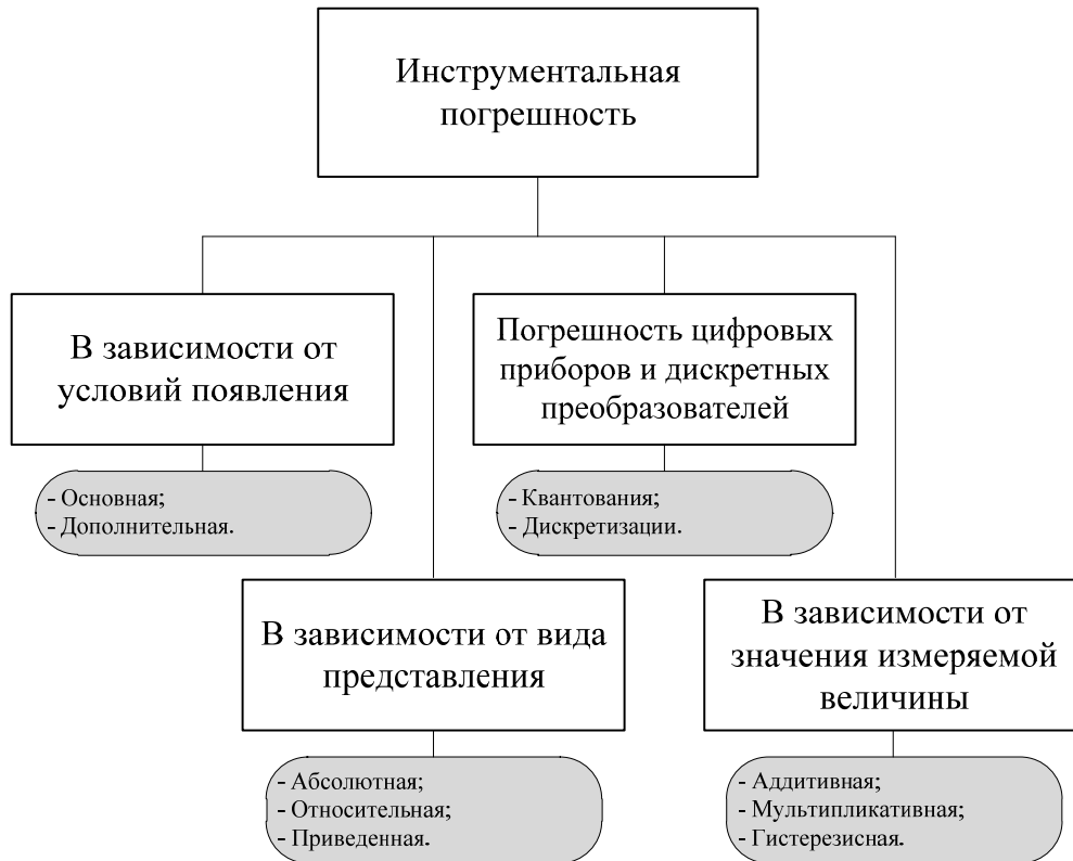
Рис. 1.4. Классификация составляющих инструментальной погрешности
