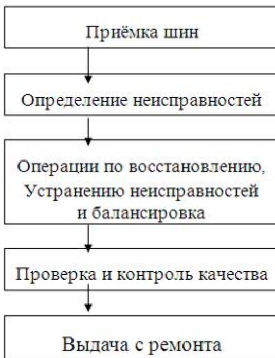
*Рис. 4. Схема технологического процесса на шиномонтажном участке.*
