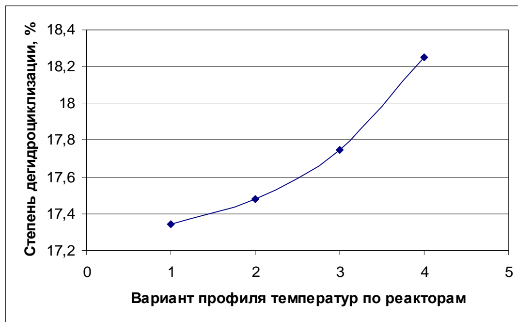
Рис.43. Изменение степени целевой реакции риформинга – дегидроциклизации парафинов при возрастающем профиле температур по реакторам
