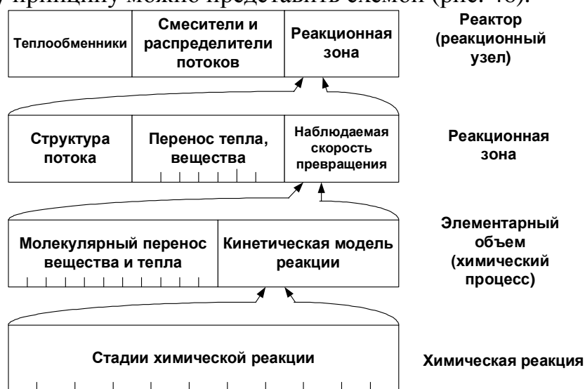
Рис. 46. Иерархическая структура построения математической модели процесса в химическом реакторе
